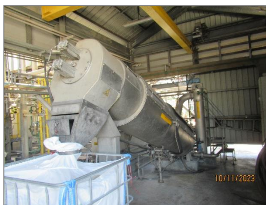
ภาพถ่ายที่ 2.2.2-22 เครื่องรีดตะกอน (Sludge Press)
